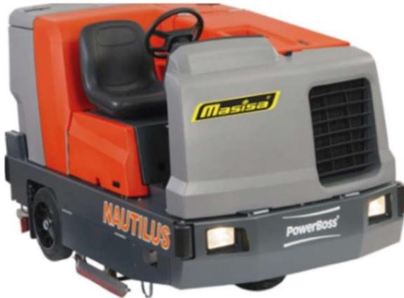
>> Fregado rápido: con un solo interruptor, el operador puede activar y desactivar todas las funciones. Las funciones (FREGADO o VACÍO) se seleccionan antes de la limpieza.
